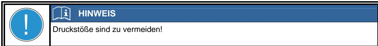
Um Druckschläge zu vermeiden sind die Pumpen gegen geschlossene Ventile anzufahren. Die Ventile im Zu- und Rücklauf sind möglichst gleichzeitig langsam zu öffnen bis die Betriebstemperatur erreicht ist.
