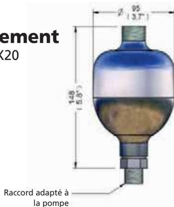
Les pompes **HEYDAC** sont des pompes à piston unique double effet et, par conséquent, produisent des faibles pulsations de pression. Celles-ci peuvent être réduites d'une manière significative grâce à l'addition d'un kit d'amortissement approprié à l'orifice d'évacuation de la pompe. Pour un amortissement maximal des pulsations, l'accumulateur devrait être installé en un point aussi proche que possible de l'orifice d'évacuation.
