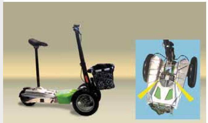
Des absorbeurs profilés qui accroissent le confort de conduite d'un scooter électrique
