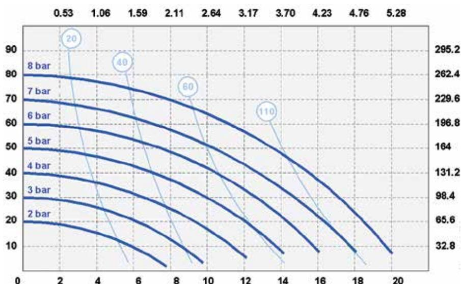
\* Les courbes et les performances se réfèrent à des pompes avec aspiration immergée et sortie fluide libre, avec de l'eau à 20 °C et varient en fonction des matériaux de composition.
