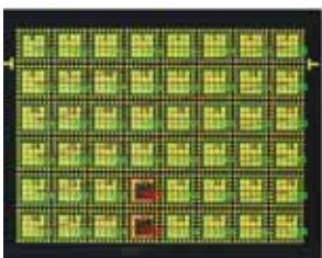
Grille d'inspection et détection des marques de rejet
