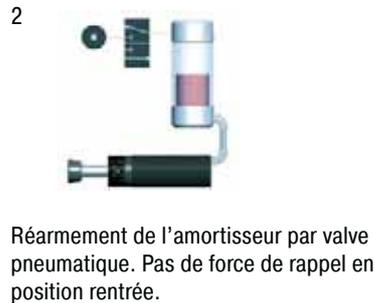
Réarmement de l'amortisseur par valve pneumatique. Pas de force de rappel en position rentrée.
