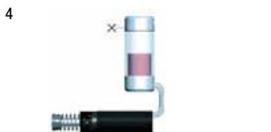
Rappel par ressort avec réservoir air/huile. Aucune alimentation en air branchée. Remarque : allongera le temps de retour.
