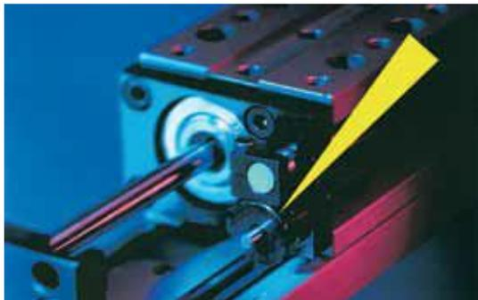
Les amortisseurs industriels ACE sont des appareils professionnels de décélération de fin de course pour les systèmes actuels d'automatisation sophistiquée. Haute capacité et construction renforcée assurent une durée de vie importante dans des conditions sévères. Une vaste gamme de taille est disponible pour des masses de quelques grammes jusqu'à plusieurs centaines de tonnes.
