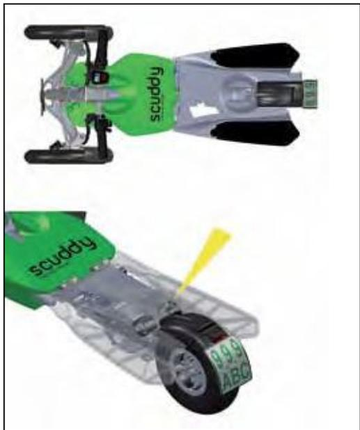
Compact, sans maintenance, confortable et aussi capable de supporter une charge de 100 kg, la construction Tandem avec les absorbeurs profilés TUBUS TR52-32H, dissipe jusqu'à 11,7 Nm par cycle.
